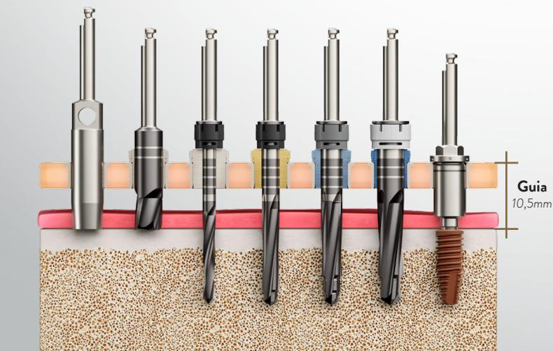
Na segunda opção, a (H6.5) a face superior da anilha fica posicionada a 10.5mm do rebordo ósseo, deixando uma área livre entre o rebordo ósseo e a face inferior da anilha de 6.5mm.
