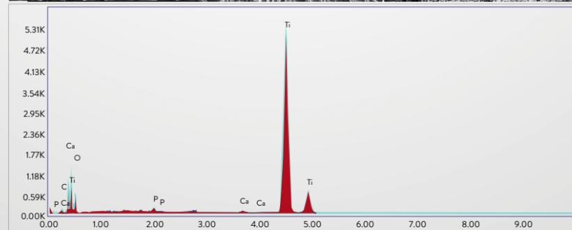
O gráfico e tabela acima corresponde a uma análise de EDS na superfície do Unitite, acercando a pureza e estabilidade da superfície do implante.
