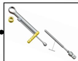
Retire a haste com graduação de torque.
